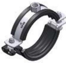
zweiteilig, verzinkt, neuer Sicherheitsverschluss mit versenkbarem Schraubenkopf, Schallschutzeinlage nach DIN 4109 aus hochwertigem EPDM, schwarz, Schallpegelverbesserung im Mittel 18 dB (A)
