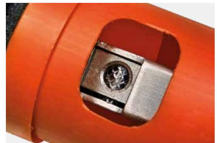
Das integrierte Bremssystem sorgt für eine sichere Handhabung.
