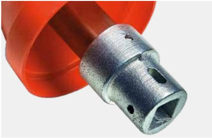
Zur exakten und sicheren Verbindung der **Kuppelmuffe** auf der Armaturenspindel sind in der Kuppelmuffe sowohl ein Langloch, als auch eine Bohrung entsprechend den Maßen des DVGW-Arbeitsblattes GW 336 eingebracht.
