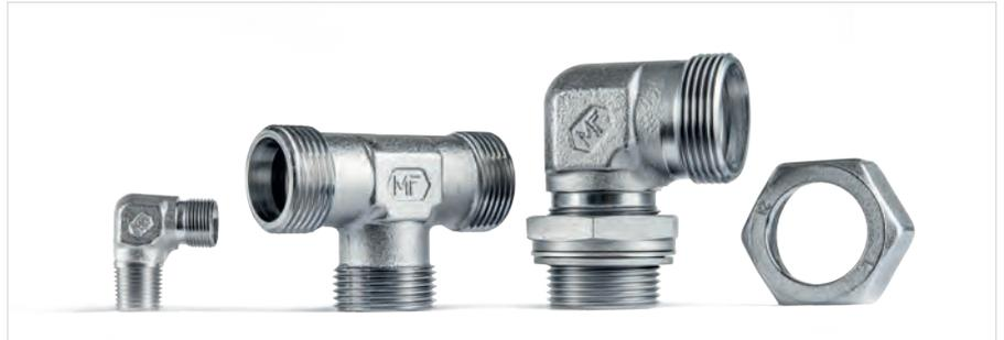
Zunächst wird eine ca. 8 µm dicke Basisbeschichtung aus Zink mit einem Nickelgehalt von 12 bis 15% und sehr homogener Verteilung der ZnNi-Moleküle galvanisch aufgebracht. Anschließend wird eine zusätzliche Passivierung mit einer Schichtdicke von ca. 500 Nanometer aufgetragen und als Abschlusschicht, eine 2 µm starke Versiegelung. Diese Schichten machen den Unterschied: Sie schützen die ZnNi-Oberfläche und verlängern damit deren Korrosionsschutzwirkung.
