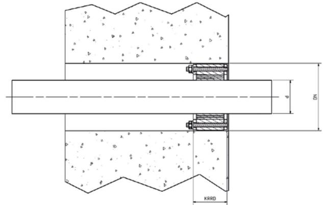
Dargestellte Abbildung mit Kunststoffstopfen im Lieferumfang der Nennweiten DN 150 und DN 200 enthalten, bei Nennweite DN 100 mit Gummistopfen.
